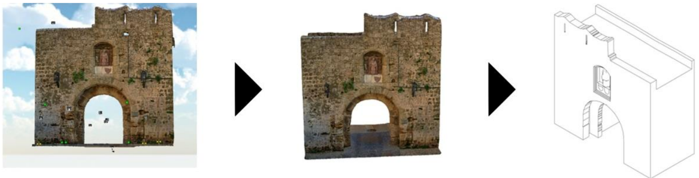
Εικόνα 2. Τρισδιάστατες αναπαράστασεις της πύλης του Αγίου Αντωνίου στη Μεσαιωνική πόλη της Ρόδου με τα επιμέρους στάδια επεξεργασίας (νέφος σημείων, meshed μοντέλο και γραμμικό σχέδιο).
