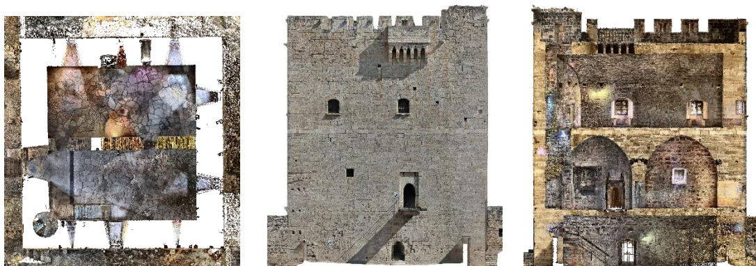
Εικόνα 10. Ορθοφωτογραφίες από το κάστρο του Κολοσσίου στην Κύπρο. Αριστερά παρουσιάζεται η κάτοψη του ισογείου στο μέσο η πρόσοψη και τα δεξιά η τομή.
