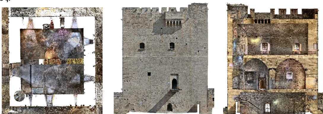
Εικόνα 8. Ορθοφωτογραφίες από το κάστρο του Κολοσσίου στην Κύπρο. Αριστερά παρουσιάζεται η κάτοψη του ισογείου στο μέσο η πρόσοψη και τα δεξιά η τομή.
